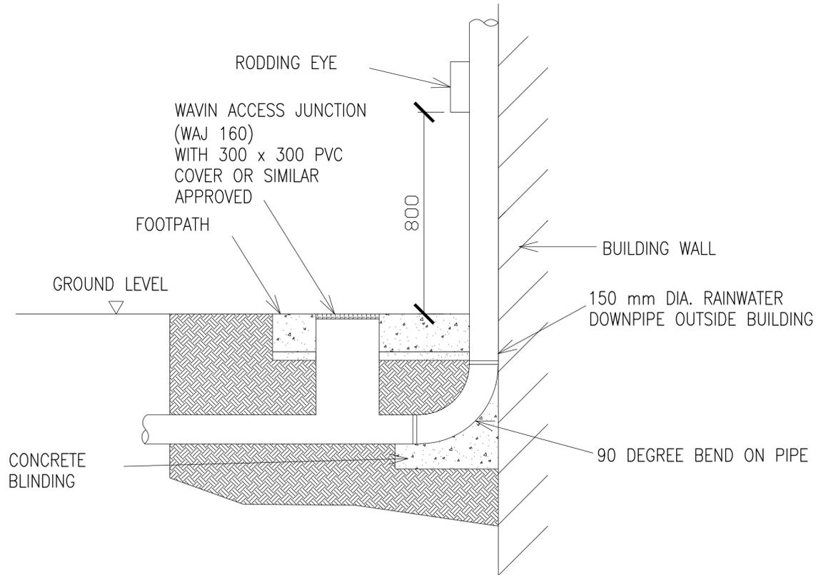
TYPICAL RAINWATER DOWNPIPE DETAIL SCALE 1:10
