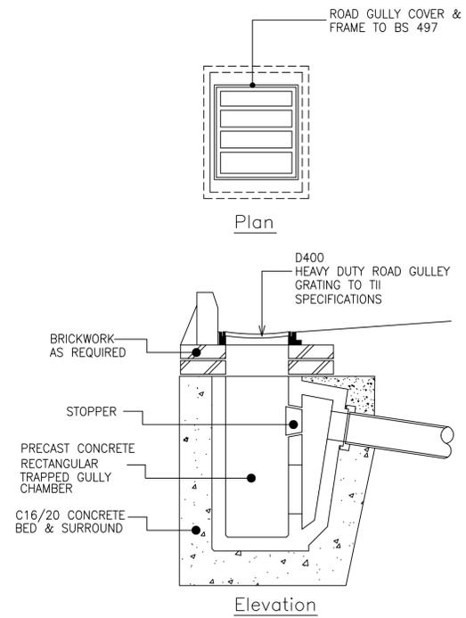
TYPICAL ROAD GULLY DETAIL SCALE N.T.S
