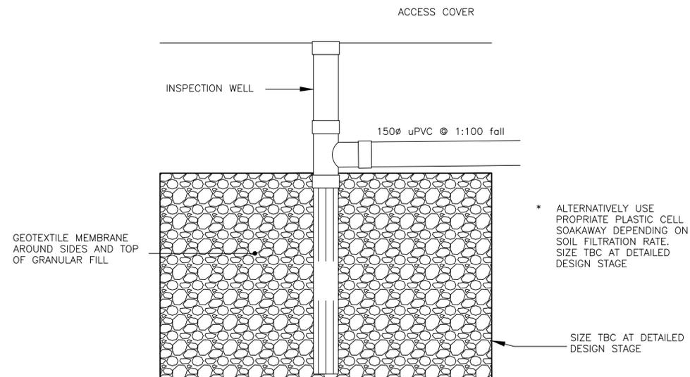
TYPICAL SOAKAWAY DETAIL SCALE N.T.S
